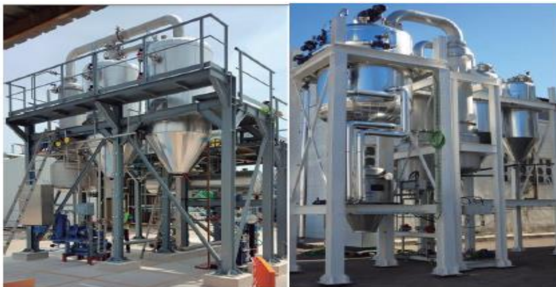
Figura 14. Equipos para el tratamiento de aguas residuales en la industria papelera. (Navarrete, 2022).
